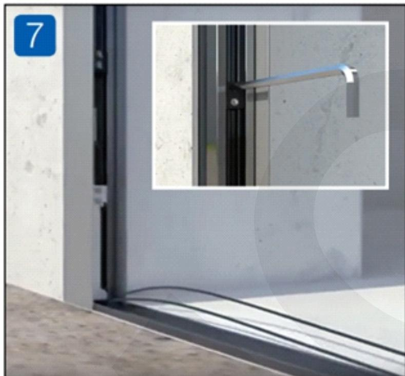
7. **PL** Pociągnąć blokadę sznurka umieszczoną w dolnej części do góry do momentu lekkiego naprężenia i dokręcić śrubę. Te same czynności wykonać dla górnej blokady sznurka przesuwając ją ku dołowi.
